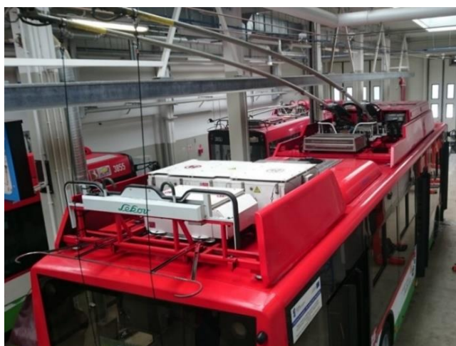
Rysunek 19 Układ jazdy autonomicznej zamontowany na dachu trolejbusu URSUS T70116
