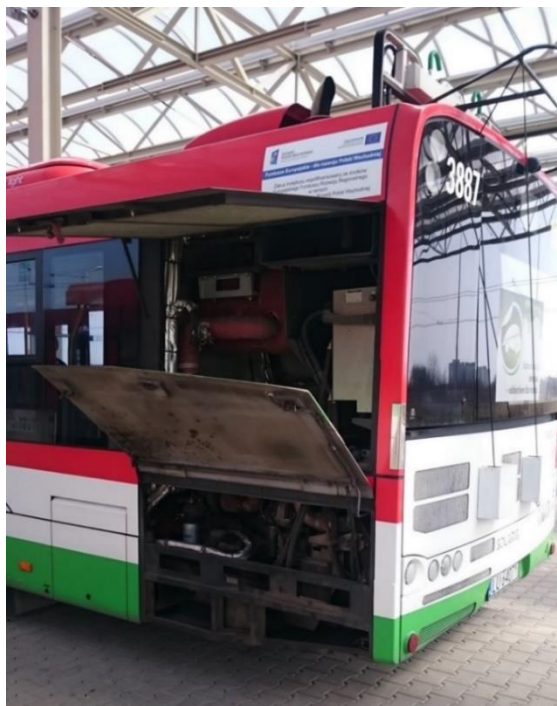
Rysunek 22 Układ jazdy autonomicznej zamontowany w zabudowie wieżowej trolejbusu Solaris Trollino 12
