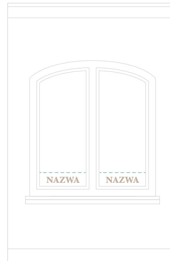
Elewacja gładka (pozbawiona boniowania)
