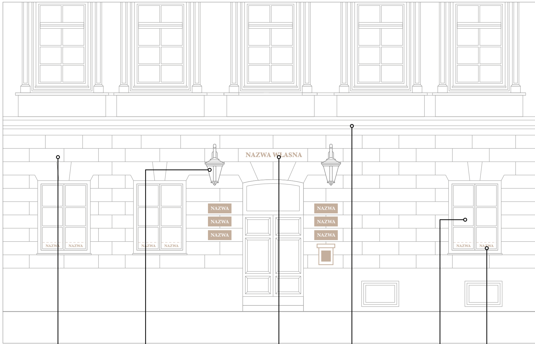
Elewacja boniowana płytowo
