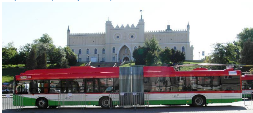
Fot. 3 Ursus T 70116 – trolejbus z baterią litowo-polimerową
