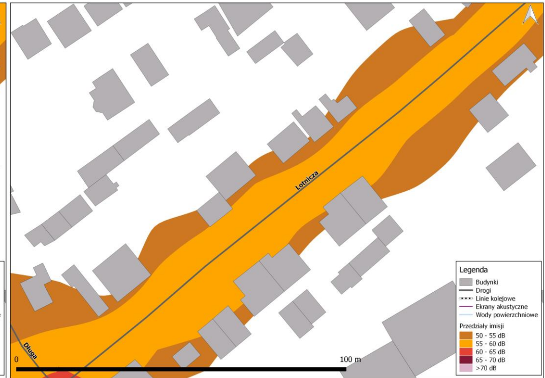
Rys. 8.12. Mapa imisji dźwięku – wskaźnik L_N , ul. Pawia na odcinku od ul. Długiej do ul. Lotniczej, po zastosowaniu działań naprawczych
