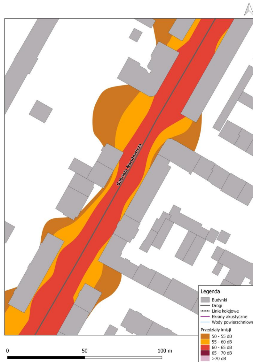
Rys. 8.32. Mapa imisji dźwięku – wskaźnik L_N , ul. Prezydenta Gabriela Narutowicza na odcinku od ul. Głębokiej do al. Józefa Piłsudskiego, po zastosowaniu działań naprawczych
