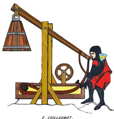
Machina oblężnicza (biffa) (oprac. D. Bednarski na podstawie ryc. E. Cuillaumot) Siege machine (biff)
