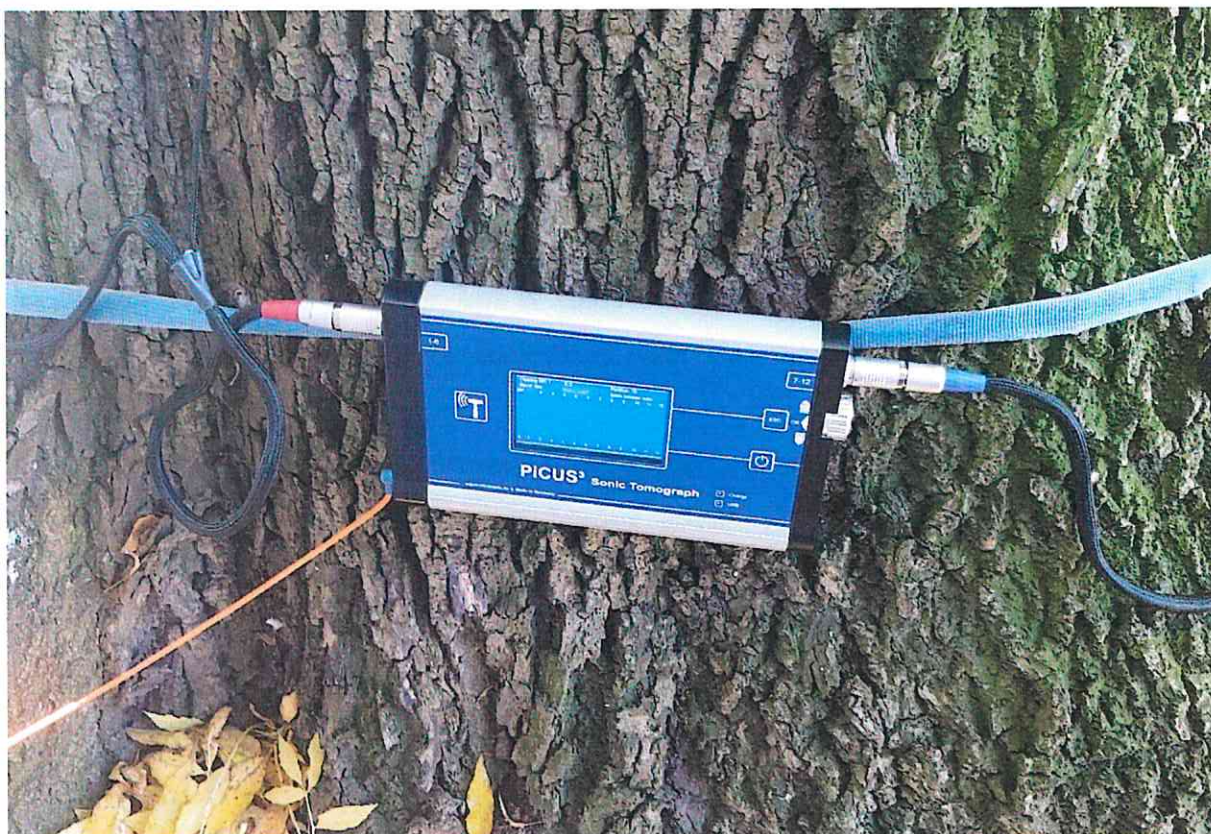
Fot. 3. Tomograf dźwiękowy Picus 3 do bezinwazyjnego badania stanu zdrowotnego drzew
